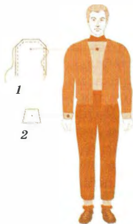
Элементы герметизации одежды: 1 — нагрудный клапан; 2 — клин
